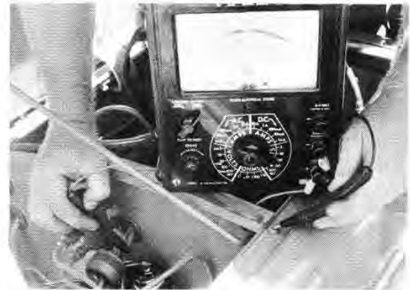
Fig. E10 — Checking the Pressure Switch
