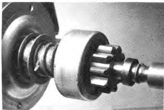
Fig. E17 — Drive the Stop Ring Back
